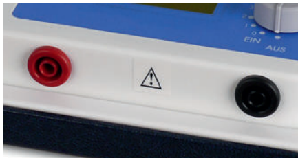
(3) Buchsen zur Verbindung von Kabeln und Elektroden
