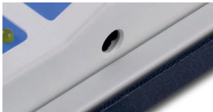
(7) Ladebuchse für das Ladegerät
