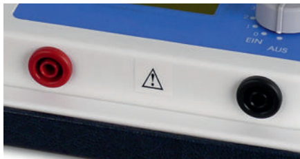
(3) Buchsen zur Verbindung von Kabeln und Elektroden
